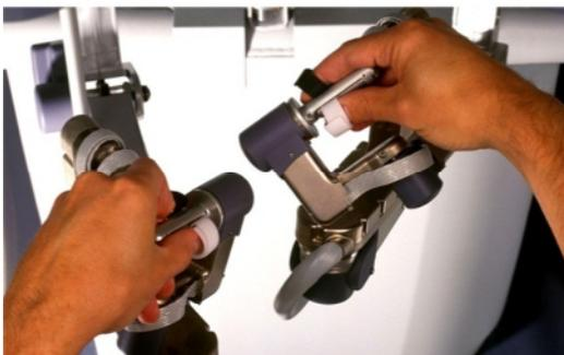
Abbildung 2: Masters (unten) und EndoWrist™-Instrumente (oben) © 2010 Intuitive Surgical Inc
