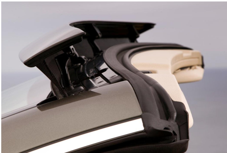
Illustration 2 Cabriolet Mercedes-Benz classe E, E 350 CGI BlueEFFICIENCY, détail du déflecteur AIRCAP® déployé
