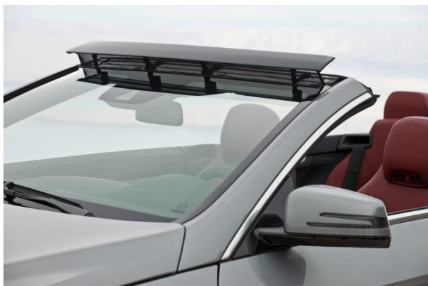
Illustration 3: Cabriolet Mercedes-Benz de classe E avec AIRCAP® déployé
