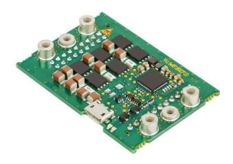
Le servocontrôleur ESCON Module 50/8 HE avec et sans dissipateur de chaleur. ©maxon motor ag
