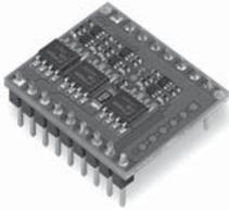
DEC Module 24/2 (Digital EC Controller) は、48 Wattまでのホールセンサ付きブラシレスモータ対応のデジタル1-Q-ECアンプです。
