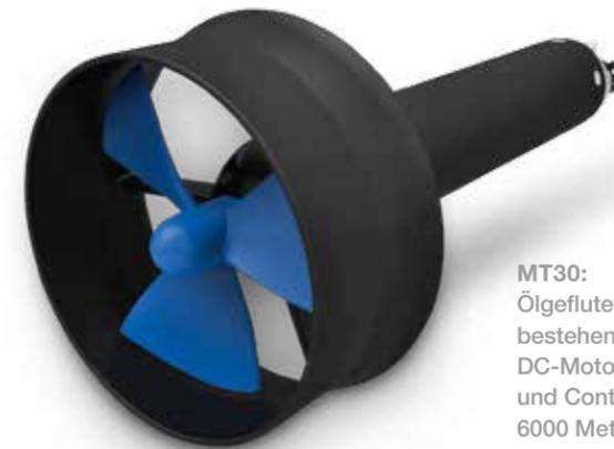
MT30: Ölgefluteter Unterwasserantrieb bestehend aus einem bürstenlosen DC-Motor, Planetengetriebe und Controller. Druckneutral bis 6000 Meter.
