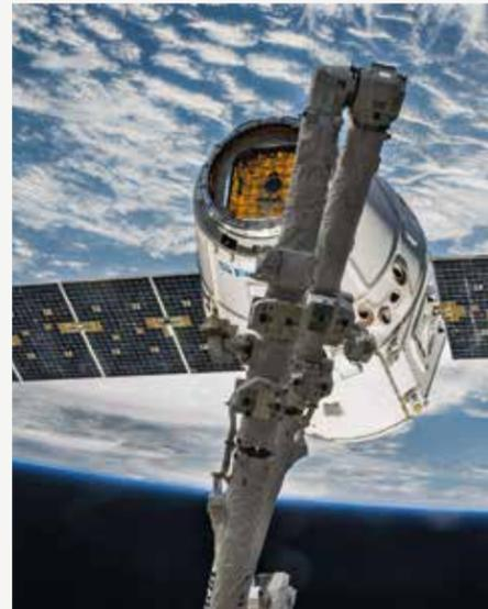
Die von SpaceX entwickelte Dragon-Kapsel, die die ISS mit Material versorgt, nutzt für die Einstellung der Sonnensegel bürstenlose Motoren von maxon.
