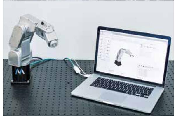
Dieser sechsbachsige Roboterarm ist halb so gross wie der bisher kleinste Industrieroboter und kann per Computer programmiert und bedient werden.
