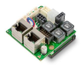
Die neue *EPOS4* Compact 50/5 EtherCAT ©maxon motor ag (56.5 x 55.0 x 31.9 mm)
