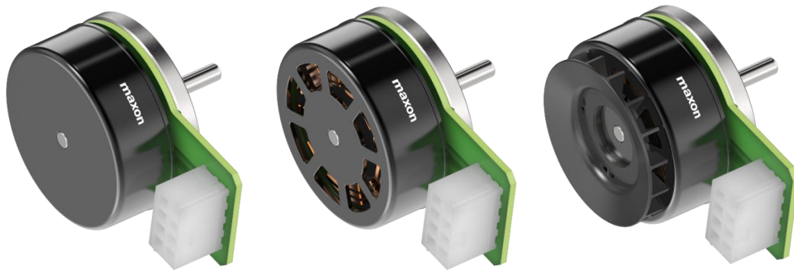
maxon EC 45 flat : Standardvariante (50/ 70 Watt) – Variante mit offenem Rotor (60 / 80 Watt) und belüftete Varianten mit optimierter Kühlung durch einen Lüfter (90/ 120 Watt) – von l.n.r.
