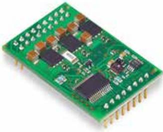
DEC Module 50/5 (Digital EC Controller) は、250 Wattまでのホールセンサ付きブラシレスモータ対応のデジタル1-Q-ECアンプです。
