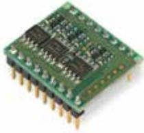
DEC Module 24/2 (Digital EC Controller) は、48 Wattまでのホールセンサ付きブラシレスモータ対応のデジタル1-Q-ECアンプです。
