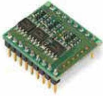
DEC 模块 24/2 (数字式EC控制器) 是1-Q放大器，用于带霍尔传感器的EC电机控制，最大输出功率为48 W。
