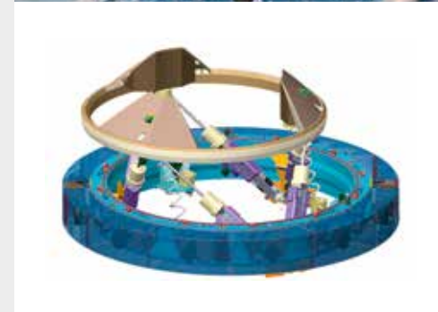
Oben Eine künstlerische Darstellung des Dream Chasers, der an der ISS andockt ist. Unten Das IBDM-System mit dem festen inneren Ring und dem flexiblen Aussenring.
