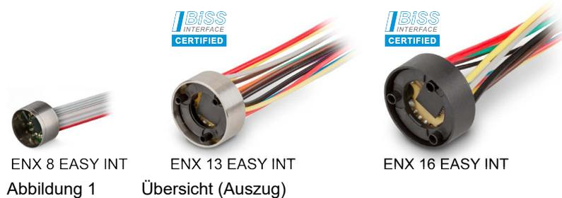
Die äusserst kompakten maxon EASY-Encoder nutzen ein interpoliertes Winkelmesssystem mittels Hall-Sensoren um Winkelinformationen mit bis zu 4096 Schritten pro Umdrehung zu generieren. Wahlweise oder in Kombination werden inkrementale Rechtecksignale, absolute Winkelwerte (SSI oder BiSS-C) und/oder Kommutierungssignale bereitgestellt.
